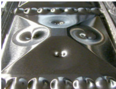
Figura 2: Particolare della geometria dell'aletta del modello di recuperatore in esame.
