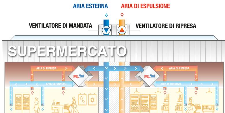
Per mantenere il giusto benessere nell'ambiente interno, occorre assicurare il corretto ricambio dell'aria. Tale processo può richiedere una notevole quantità di energia, la quale può essere considerevolmente ridotta con l'impiego di un recuperatore di calore. Prendiamo in analisi un supermercato di superficie pari a 1235 m<sup>2</sup>, con un affollamento medio di 310 persone. Per ricambiare l'aria sono necessari
