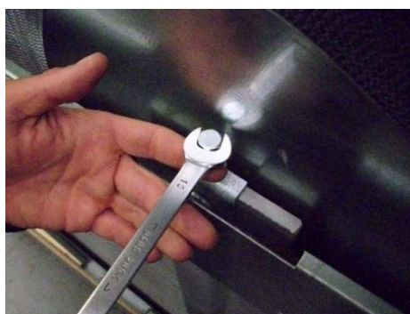
3) Regolare la convergenza della ruota attraverso la vite verticale (vite 2)
